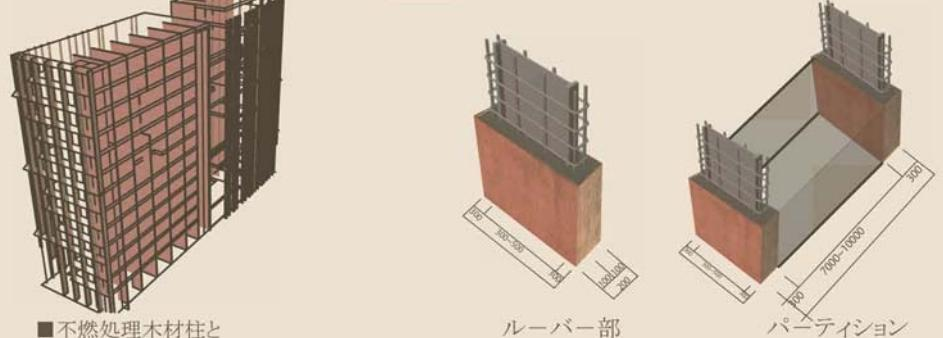
建物全体を剛強な鉄骨鉄筋コンクリート造耐震壁付きラーメン構造を探用し、大きな吹き抜け空間や緑化を同時に成立させる計画とした。また構造体であるとともにルーバーとパーティションの機能を同時に果たし空間のしきり、彩光、通風の変化をもたらす機能を合わせ持つ。
