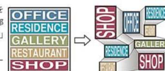
①周辺環境に合わせて、様々なウィンドウを3D空間上に配置する。 ②レベル差が小さいウィンドウをスラブで繋ぎ、さらに上下動線を確保する。 ③ウィンドウを浮かび上がらせるようにファサードの曲面をデザインする。
