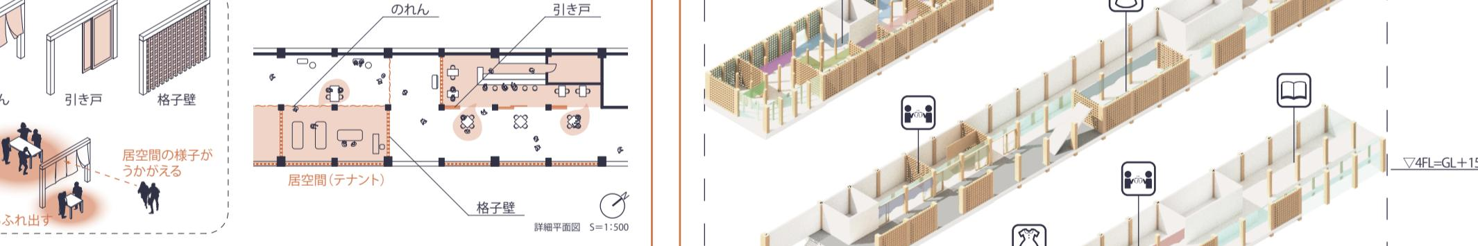
05 構造計画 木製耐力格子壁の配置
