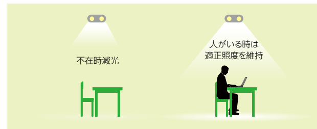
人感センサーの動作原理
