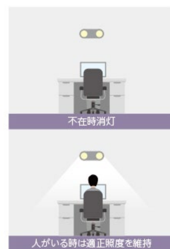
人感センサーの動作原理
