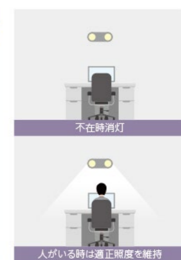
人感センサーの動作原理
