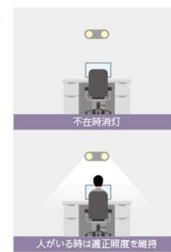
人感センサーの動作原理
